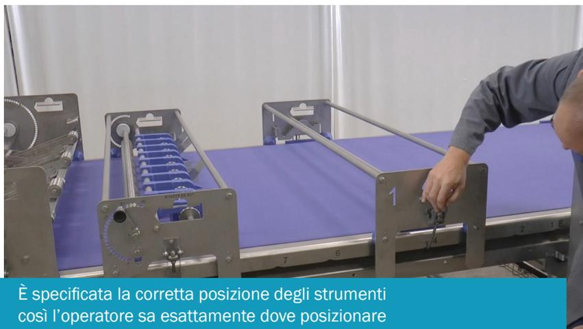
È specificata la corretta posizione degli strumenti così l'operatore sa esattamente dove posizionare lo strumento sulla linea
