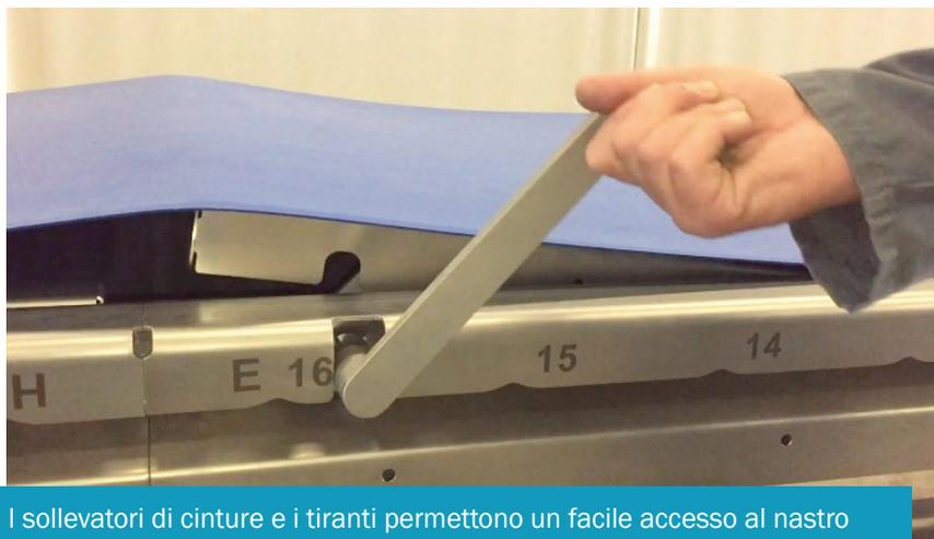
I sollevatori di cinture e i tiranti permettono un facile accesso al nastro di trasporto e al telaio. Questo permette una asciugatura più veloce e profonda della macchina dopo essere stata igienizzata
